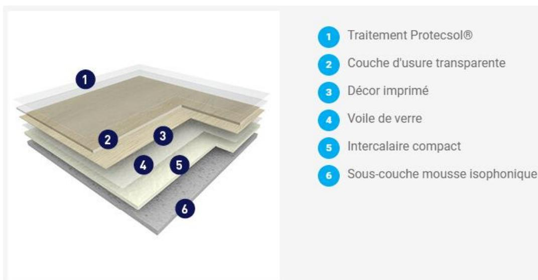
Figure 2 : illustration du principe de fabrication du produit Taralay Initial Compact
